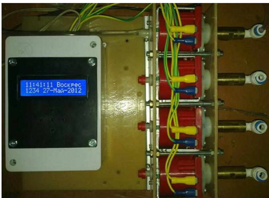
Цифро-буквенная информация о работе дозатора выводится на знакосинтезирующий LCD дисплей 2 строки по 16 символов. Меню устройства русифицированное.
