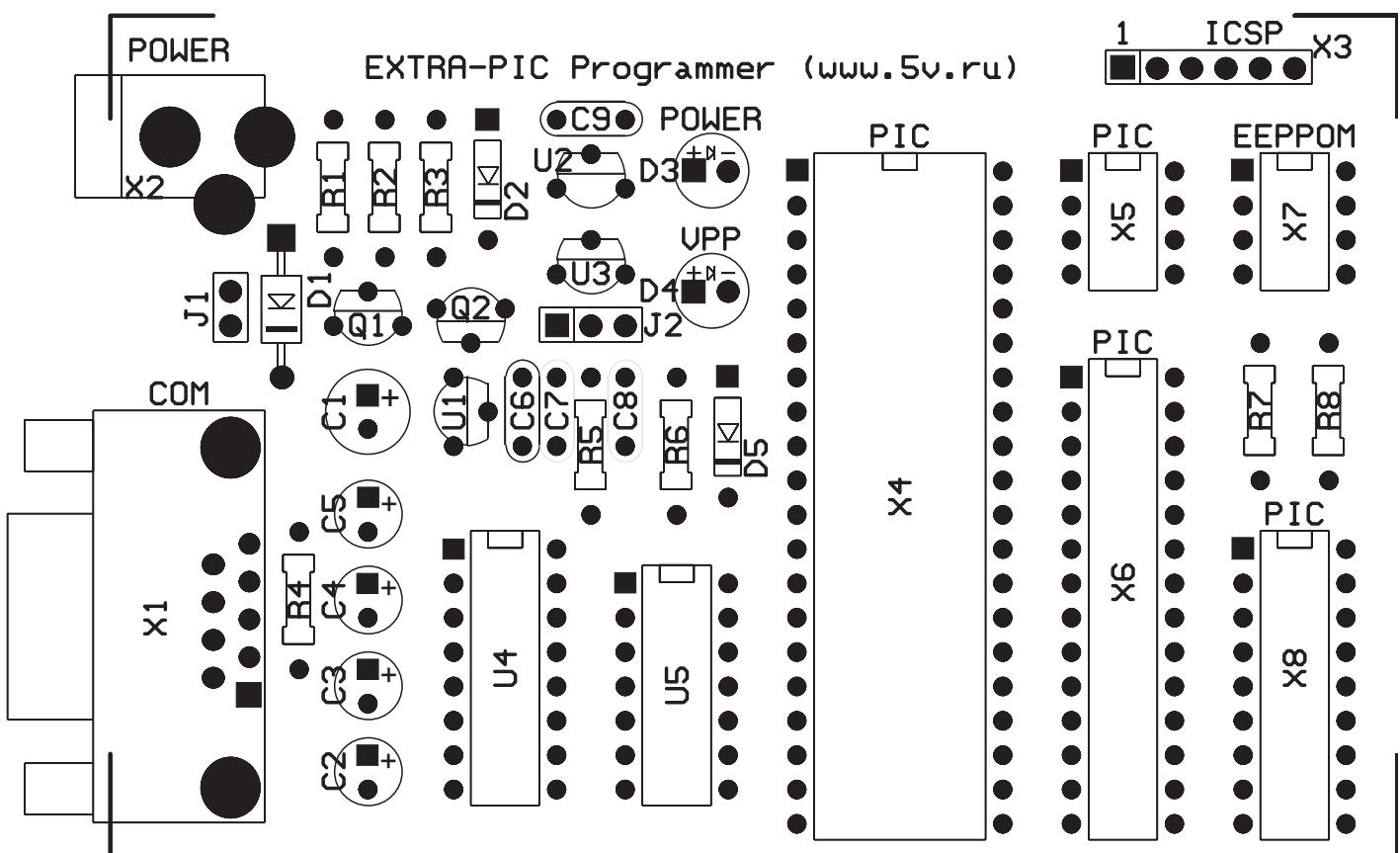
Рис. 2 Монтажная схема программатора EXTRA-PIC. DOC Rev.1.03.00
