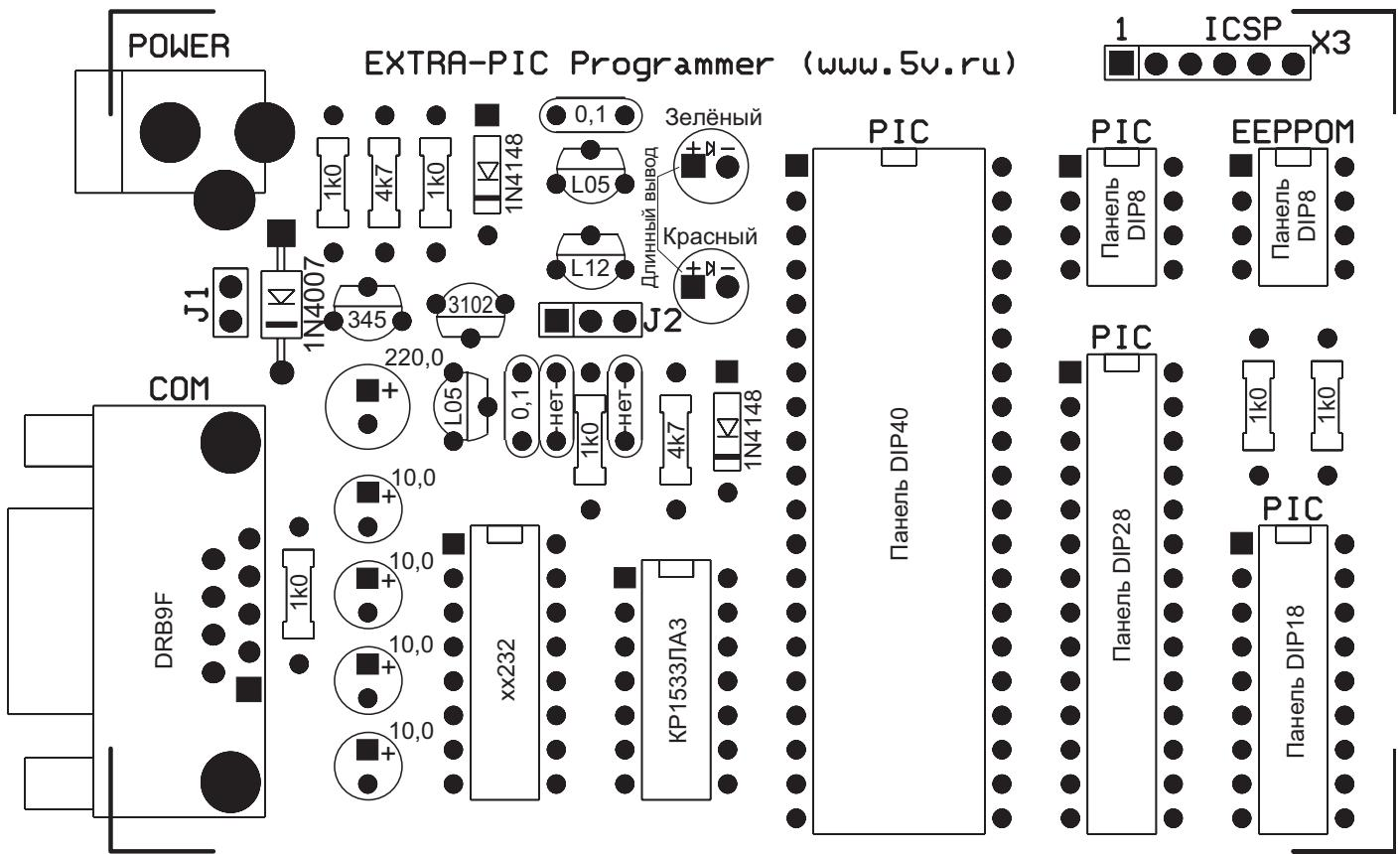
Рис. 3 Быстрая монтажная схема программатора EXTRA-PIC. DOC Rev1.03.00
