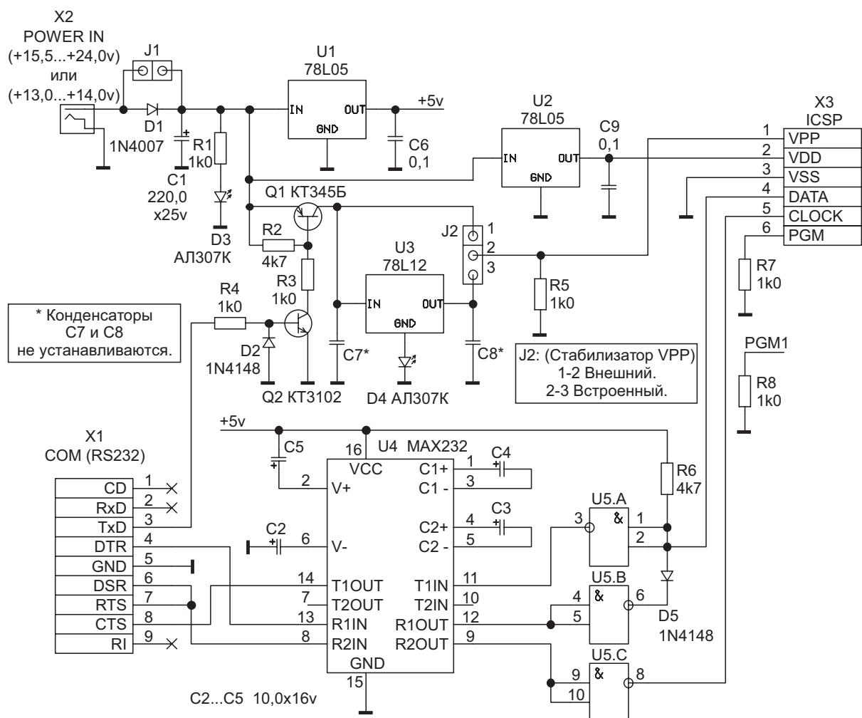
Рис. 1 Схема электрическая принципиальная программатора EXTRA-PIC. DOC Rev.1.03.00
