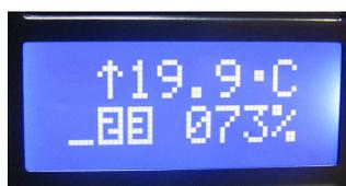
Уровень мощности в диммируемом канале (PWM\DIMM)
