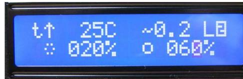
Инверсия силовой нагрузки термостата - ↑ \ ↓ (нагрев\охлаждение)
