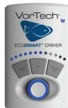
Иллюстрация выше отображает привод EcoSmart в режиме коротких импульсов (синий диск управления). Светодиоды с тусклым накалом показывают заданную скорость.
