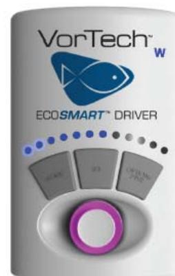
Иллюстрация выше показывает привод EcoSmart в режиме EcoSmart (пурпурный диск управления). Первый и второй ярко горящие светодиоды указывают на то, что этот привод настроен на режим прилива EcoSmart, при этом менее яркие светодиоды указывают на параметры скорости.
