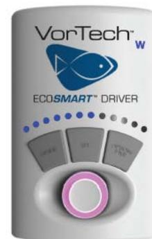
Иллюстрация выше отображает привод EcoSmart в режиме длинных импульсов (розовый диск управления). Светодиоды с тусклым накалом указывают заданную скорость.
