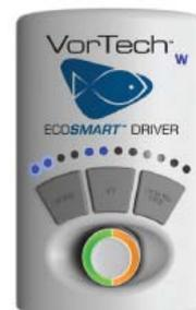
Показанный привод находится в режиме настройки скорости ночного режима и устанавливает самую низкую скорость, отображая, что установлена скорость по умолчанию 3.
