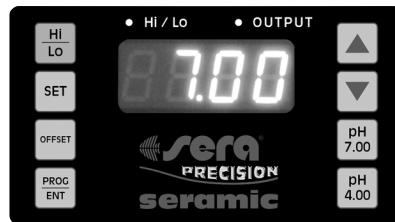
**pH 7** Elektrodu opláchněte destilovanou vodou a ponořte ji do zeleného **sera kalibračního roztoku pH 7,0**. Počkejte minimálně 60 sekund. Současně stiskněte tlačítka
