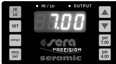
pH 7 Aclare el electrodo con agua destilada y introduzcalo en la SERA solución de comprobación pH 7,0, de color verde. Espere un mínimo de 60 segundos. Pulse simultáneamente las teclas
