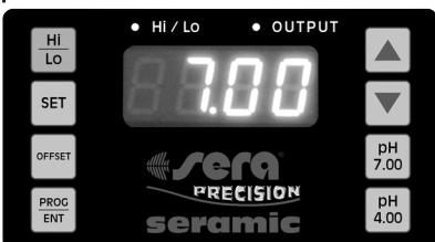
**pH 7** Ополосните электрод дистиллированной водой и погрузите его в **SERA тестовый раствор pH 7,0** зеленого цвета. Ждите в течение, по крайней мере, 60 секунд. Нажмите одновременно клавиши
