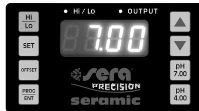
**pH 7** Elektrodun saf suyla çalkalayıp ve yeşil renkli sera test çözeltisi pH 7,0 içerisinde batırın. En az 60 saniye bekleyin
