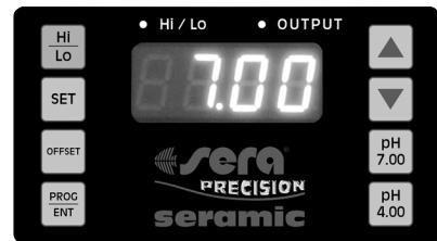
**pH 7** Spülen Sie die Elektrode mit Destwasser ab und stecken Sie diese in die grüne sera Prüflösung pH 7,0. Warten Sie mindestens 60 Sekunden. Drücken Sie gleichzeitig die Tasten
