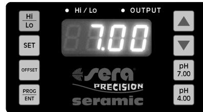
pH 7 Optłucz elektrodę wodą destylowaną, a następnie włoż do zielonego odczynnika SERA test solution pH 7,0. Poczekaj przynajmniej 60 sekund. Naciśnij jednocześnie przyciski
