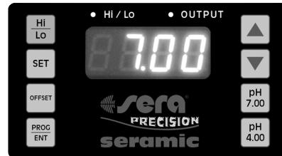
**pH 7** Enxágue o eléctrodo com água destilada e introduza-o na SERA solução padrão pH 7,0 verde. Espere pelo menos 60 segundos. Pressione ao mesmo tempo as teclas
