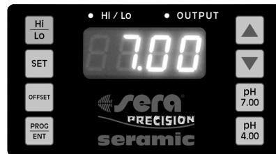
pH 7 Izperite elektrodo z destilirano vodo in jo dajte v sera poskusno tekočino pH 7,0. Počakajte najmanj 60 sekund in hkrati pritisnite tipki
