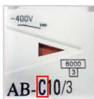
Кривая отключения «С» - отражает порог срабатывания автомата при защите от перегрузки и короткого замыкания. Кривая С - ток в цепи в 5-10 раз больше номинального. Используют в современном жилом строительстве и в офисных сетях.
