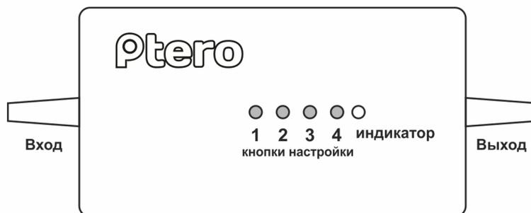
Управление контроллером осуществляется при помощи четырех тактовых кнопок и двухцветного светодиода.
